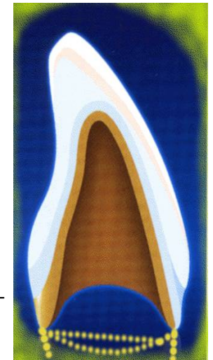
Abbildung 1: Schichtung einer Metallkeramikkrone
